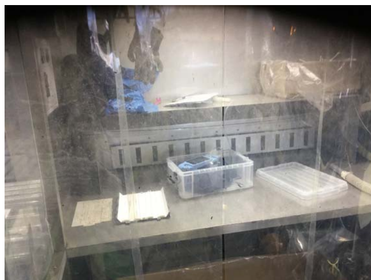
蛍光管取り外し 簡易ドラフトチャンバー （水銀対策）
